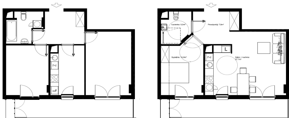
Rysunek 1. Rzut mieszkania przed (po lewej) i po zmianach lokatorskich (po prawej) przystosowujących je do użytkowania przez osobę na wózku inwalidzkim, opracowanie własne
